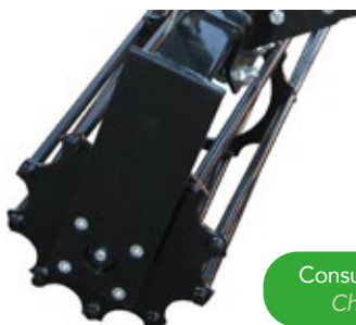
Rouleau cage Ø 400 mm avec 10 barres 25 mm
