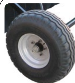
Pneumatiques 10,0/75-15,3" et 400/60-15,5" (14PR) 34 à 36 disques.
