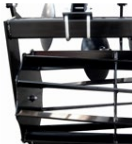
Rouleau cage Ø 300 mm avec 9 fer plats 40x8 mm Ø 300 mm cage roller with nine 40x8 mm flat plate
