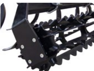
Rouleau cage Ø 550 mm avec 10 Barres crantées de 60x8 mm
