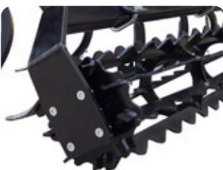
Rouleau cage Ø 460 mm avec 9 Barres crantées de 60x8 mm
