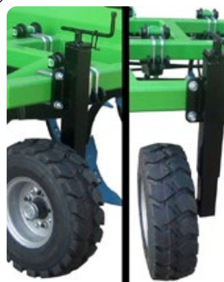
Paire de roues pneumatiques avec manivelle: 18x7-8" (Ø 490x150) et 6.50x10" (Ø 590x140)
