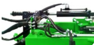
Régulation hydraulique du niveau des trains de disques Hydraulic regulation of the level of the sets of discs
