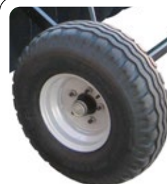
Pneumatiques 400/60-15,5" (14PR) 34 à 36 disques. Pneumatic wheel 400/60-15,5" (14PR) 34 to 36 discs
