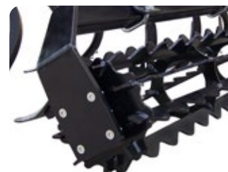
Rouleau cage Ø 550 mm avec 10 Barres crantées de 60x8 mm Ø 550 mm cage roller with 10 wavy bars 60x8 mm
