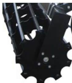
Rouleau cage Ø 550 mm 9 Barres carrées · 25 mm Ø 550 mm cage roller with nine 25 mm square bars
