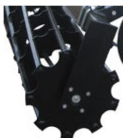
Rouleau cage Ø 550 mm. 9 Barres carrées · 25 mm
